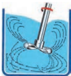
شکل ۳-۲۸- قرار دادن همزن خارج از مرکز و افزایش آشفته‌گی سیال
