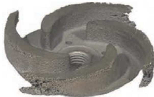
شکل ۳-۱۹- آسیب دیدگی پروانه پمپ در اثر پدیده کاویتاسیون
