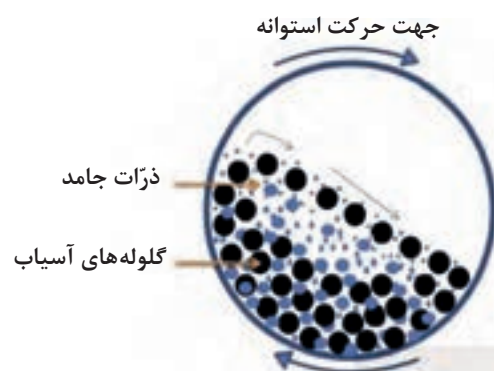
شکل ۴۳-۳- نمایی از سطح مقطع آسیاب دوار (گلوله‌ای)
