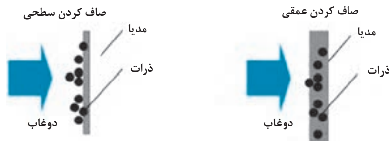
شکل ۶- انواع فیلتراسیون (بر حسب چگونگی حرکت سیال)
