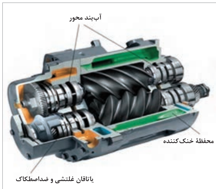
شکل ۳۴- برشی از کمپرسور
