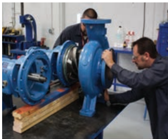
شکل ۲- تعمیر اساسی پمپ در کارگاه مکانیک
