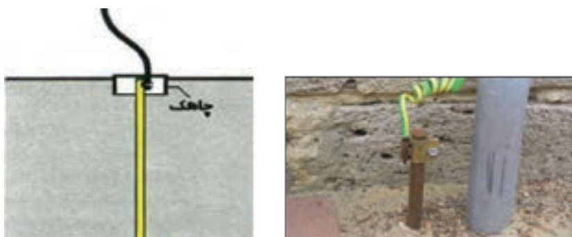
شکل ۴ - شیوه اتصال به چاه ارت
