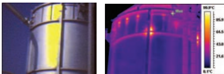
شکل ۱۳- تشخیص نشتی حرارتی از عایق مخازن
