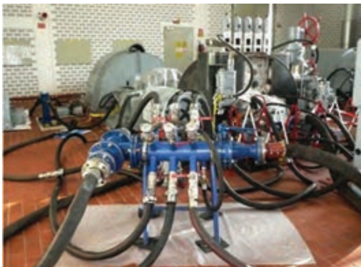
شکل ۳۰- سامانه تمیزکاری کمپرسور
