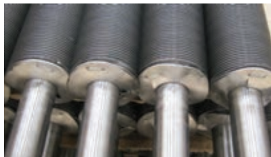
شکل ۲۶- لوله‌های پره‌دار در خنک‌کننده‌های هوایی
