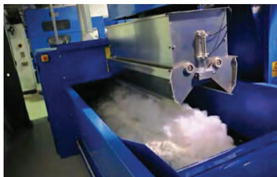
شکل ۵- سیستم تغذیه با یک ترازو (وزنی)
