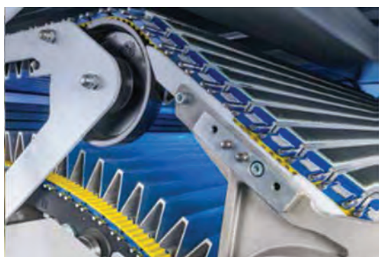
شکل ۲۹- حرکت پروفیل های فلت روی تسمه های کلاهد
