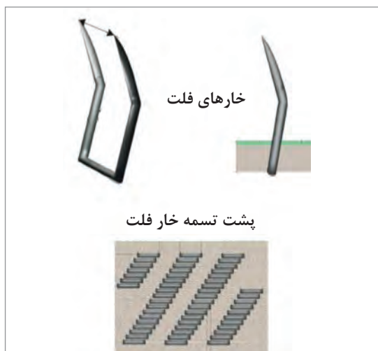
شکل ۲۸- شکل سوزن های انعطاف پذیر فلت باروکش مناسب
