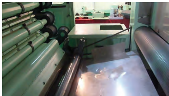
شکل ۱۰- سینی و غلتک تغذیه در سیستم قدیمی
