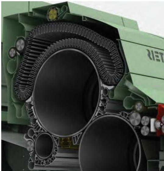
شکل ۲۶- شکل کلاhek و موقعیت نصب آن روی سیلندر اصلی
