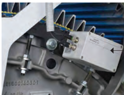
شکل ۳۵- موتور تنظیم فاصله کلاهدک و سیلندر (PFS-M)
