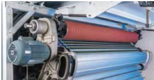
شکل ۳۶- دستگاه سنگ‌زدن فلت‌های کلاhek
