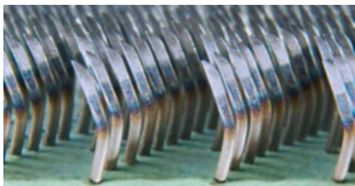
شکل ۱۹- سطح سیلندر اصلی پوشش داده شده با نوار متالیک
