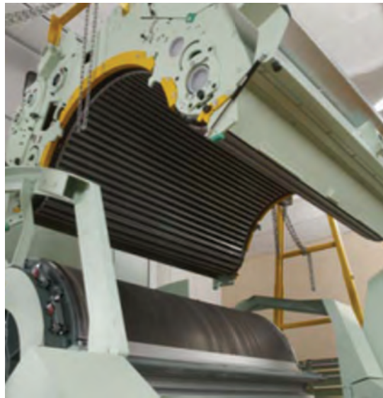
شکل ۲۶- شکل کلاhek و موقعیت نصب آن روی سیلندر اصلی
