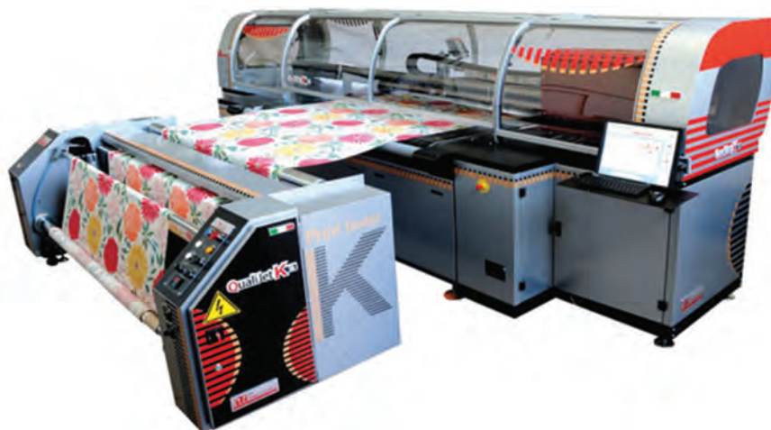
شکل ۱۰- ماشین چاپ دیجیتال با خشک کن
