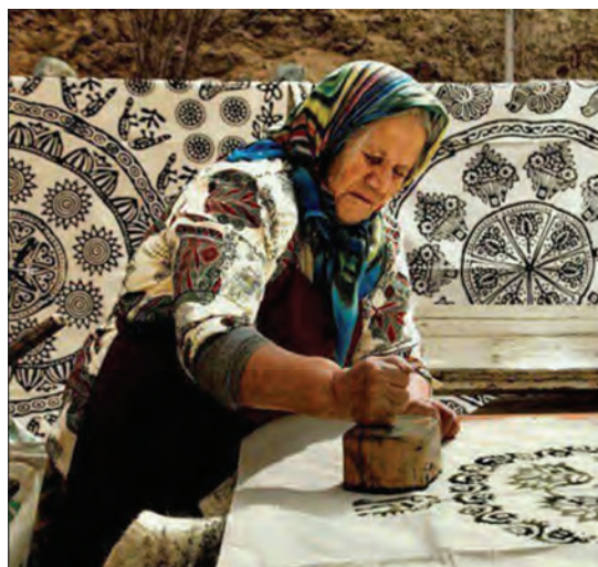
شکل ۵- چاپ به روش مهر زدن
