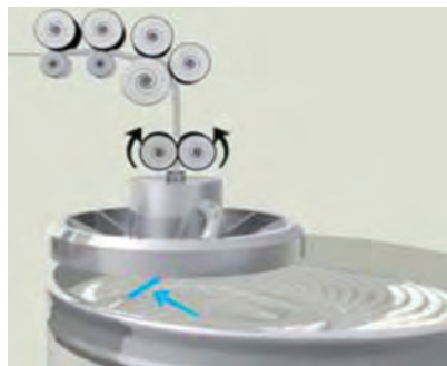
شکل ۱۲- کویلر و نحوه قرار گرفتن فتیله در بانکه
