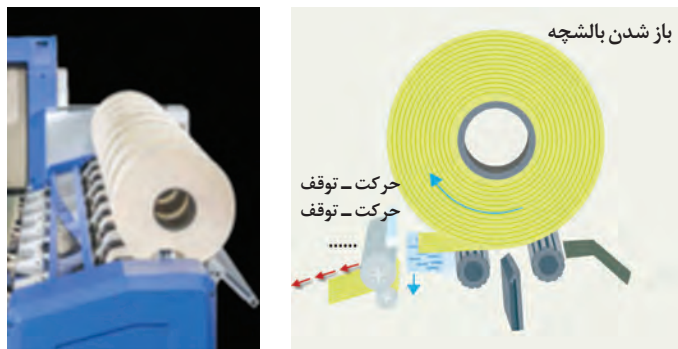
شکل ۳۲- بخش باز شدن لایه بالشچه یا تغذیه
