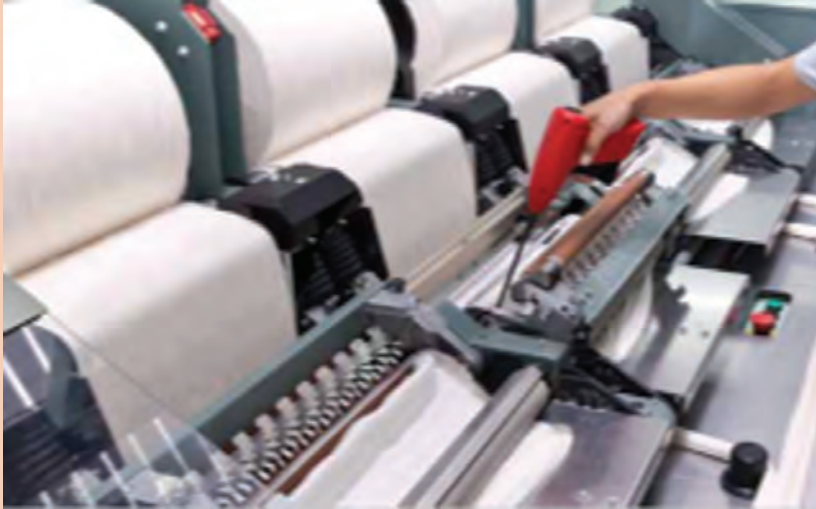
شکل ۴۳- روش پرزگیری با تفنگی پرزگیر
