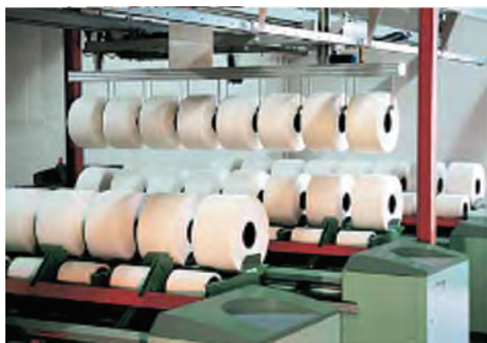
شکل ۲۸- نحوه قرارگیری بالشچه‌ها روی دستگاه شانه
