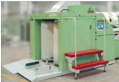
شکل ۴۱- بخش تولید و بانکه پرکنی
