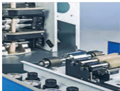
شکل ۱۱- کالندر و اتولولر در چندلاکنی
