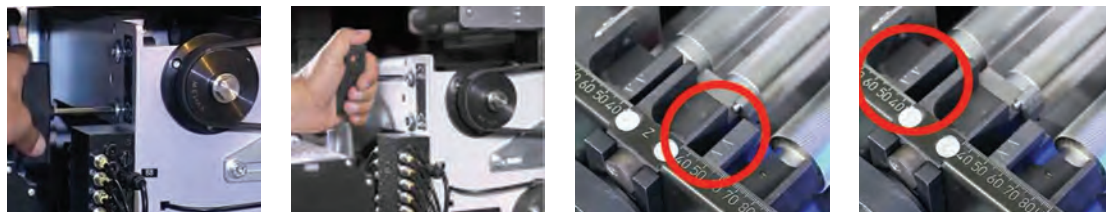
شکل ۹- تنظیم فاصله نواحی کشش بین غلتک‌ها
