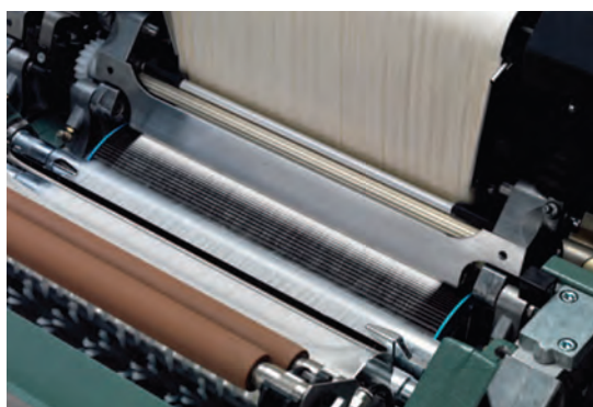
شکل ۳۱- یک واحد چشمه از یک ماشین شانه‌زنی و اجزای آن
