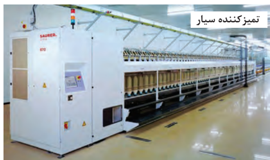
شکل ۵۲- تمیزکننده سیار روی فلایر
