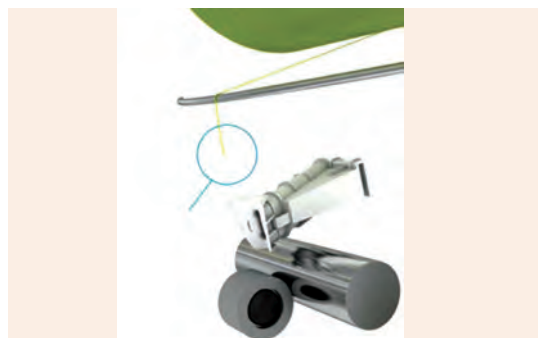
شکل ۷- پیوند نیمه اتوماتیک نخ در ماشین این اند
