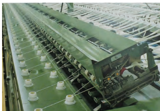
شکل ۳۳- خروج نیمچه نخ از منطقه کشش
