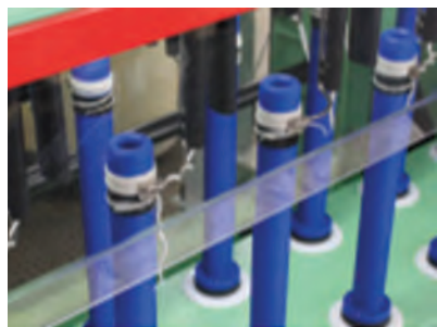
شکل ۳۵- بوبین پلاستیکی نصب شده روی دوک
