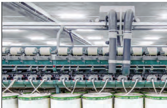
شکل ۱۶- تمیزکننده سیار روی ماشین چرخانه
