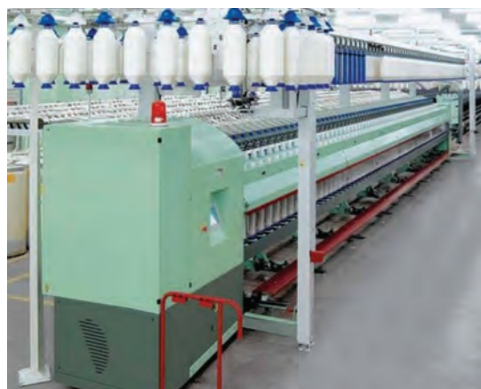
شکل ۱۹- نمایی از ماشین فلایر (نیم تاب)
