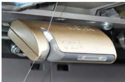
شکل ۱۴- کنترل‌کننده و تمیزکننده نخ
