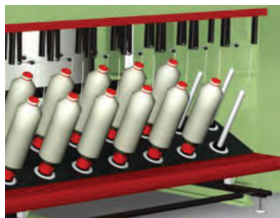
شکل ۴۷- شکل داف کردن بوبین
