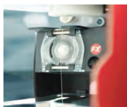
شکل ۴۵- کنترل‌کننده تمیزکننده و قطع‌کننده نخ
