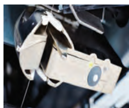
شکل ۴۵- کنترل‌کننده تمیزکننده و قطع‌کننده نخ
