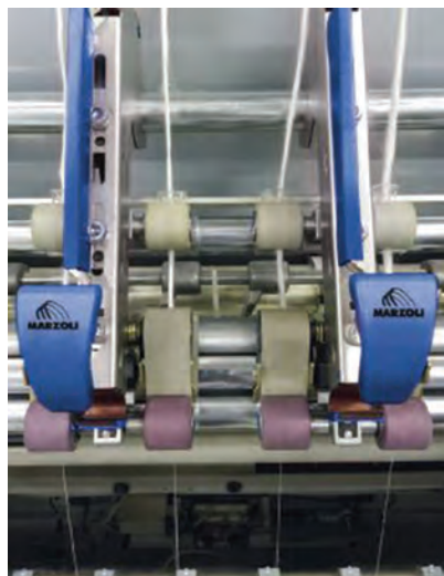
شکل ۹- تصویر واقعی سیستم کششی در رینگ
