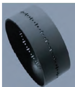
شکل ۱۸- آپرون مشبک سیستم کامپکت
