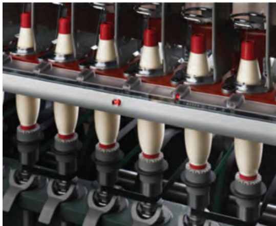
شکل ۳- فاصله دو دوک متوالی در دستگاه رینگ
