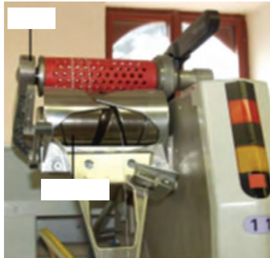
شکل ۵۲- شروع پیچش یک قرقه جدید
