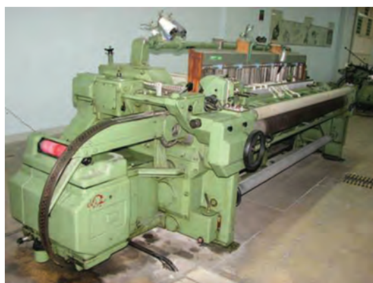
شکل ۱۷- ماشین بافندگی با پودگذاری راپیر
