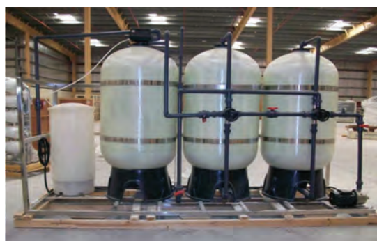
شکل ۶۲- نمونه یک دستگاه سختی‌گیر آب است.
