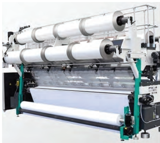
شکل ۲۵- ماشین بافندگی حلقوی تاری
