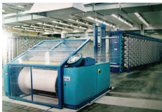
شکل ۱۴- یک دستگاه چله پیچی
