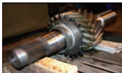
شکل ۳۹- نمونه‌هایی از چرخ‌دنده حلزونی
