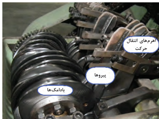
شکل ۵۴- بادامک‌ها در ماشین بافندگی
