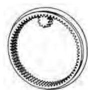
شکل ۴۱- چرخ‌دنده متداخل
