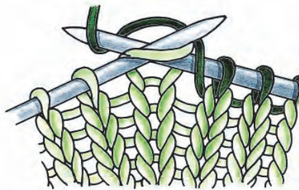
شکل ۲ نحوه تهیه بافت حلقوی پودی و نمونه بافته شده آن با دست
