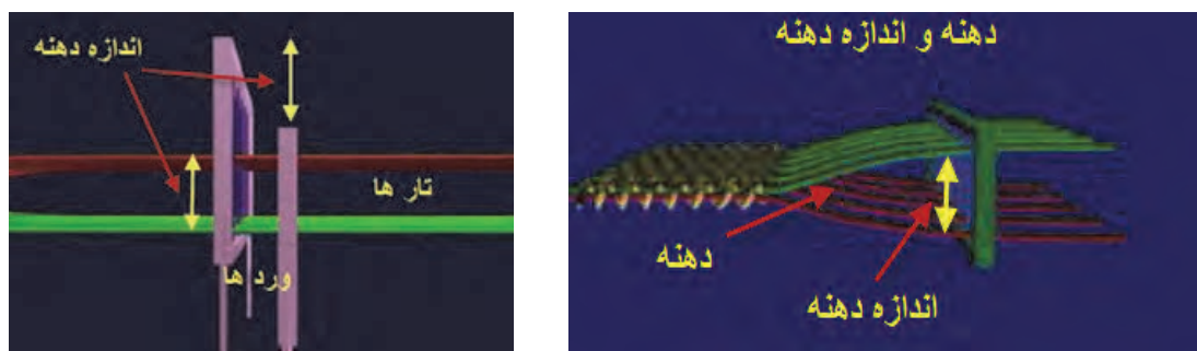
شکل ۴۴ تشکیل دهنه و اندازه آن
