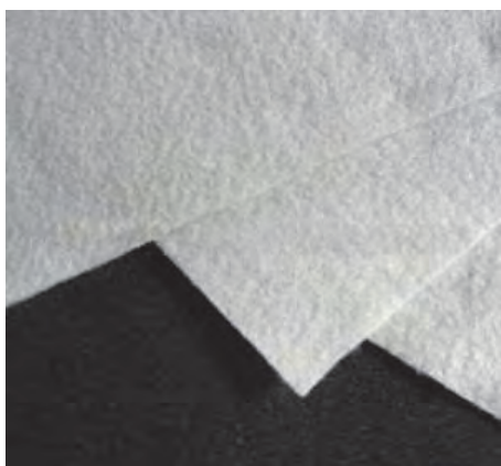
شکل ۷ نمونه‌ای از منسوجات بی‌بافت تهیه شده از طریق سوزن زنی
