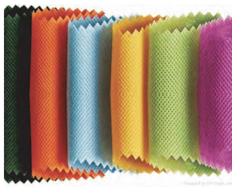
شکل ۸ منسوج بی‌بافت تهیه شده از طریق روش حرارتی منسوج تهیه شده از طریق فشار آب
