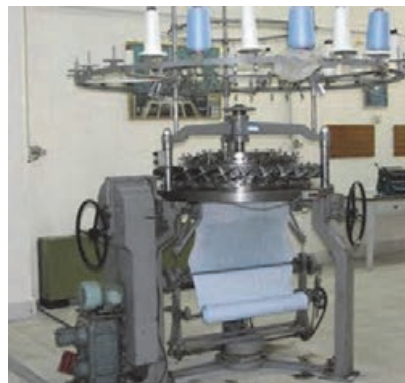
شکل ۳ دستگاه بافندگی با ساختار حلقوی پودی و انواع سوزن‌ها
