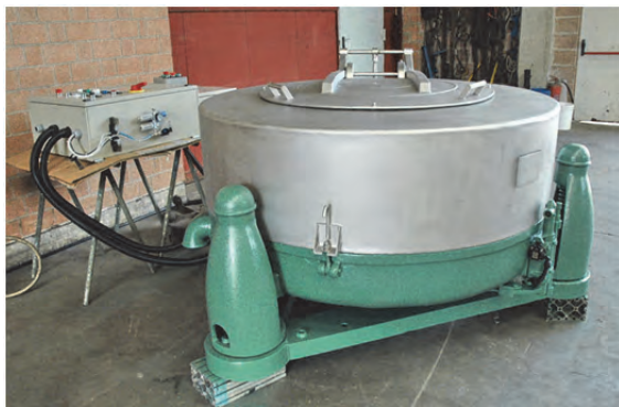
شکل ۹ سانتریفوژ آگیری و نحوه آویزان کردن کلافها در فضای باز جهت خشک شدن
