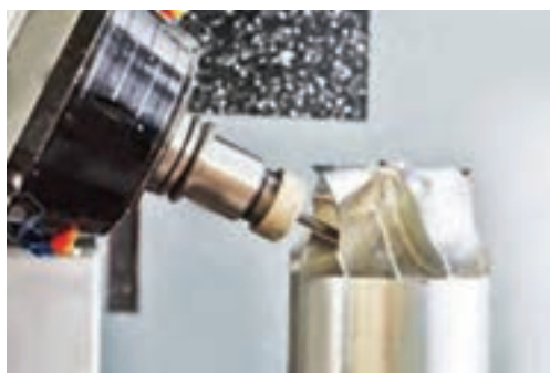
شکل ۱۴- برش فلز با دستگاه CNC
