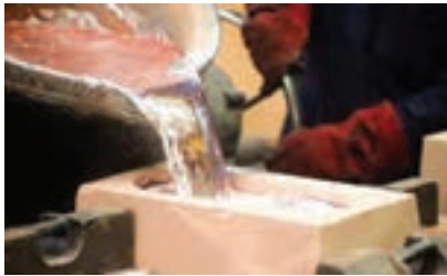
شکل ۳- ریخته‌گری فلز آلومینیوم
