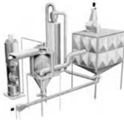
شکل ۱۸- سیستم سایش نیوماتیکی برای احیای ماسه به روش خشک
