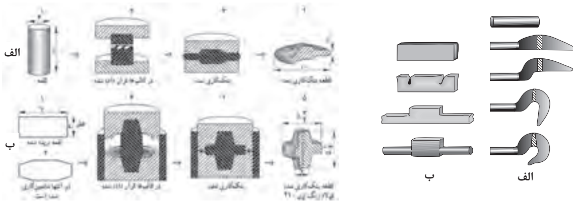
شکل ۳۰- مراحل تهیه دو قطعه به روش پتک کاری بدون استفاده از قالب
