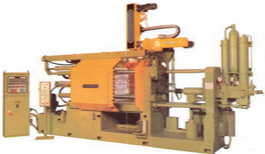
شکل ۸- ماشین ریخته‌گری تحت فشار با محفظه سرد
