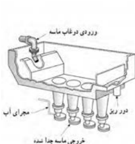
شکل ۱۹- سیستم سایش ماسه برای احیای ماسه به روش تر شکل ۲۰- سیستم جداکننده هیدرولیکی در احیای ماسه به روش تر
