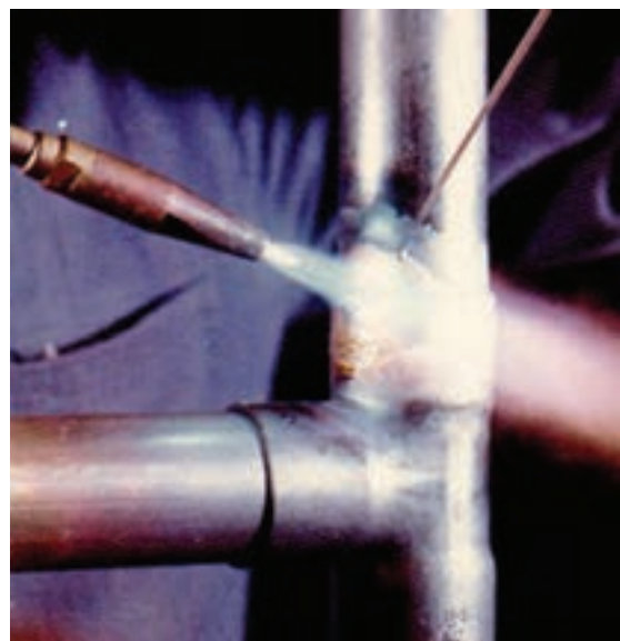
شکل ۳۳- تکنیک جوشکاری به روش اکسی استیلن
