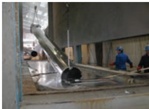
شکل ۲۵- فرایند گالوانیزه کردن
