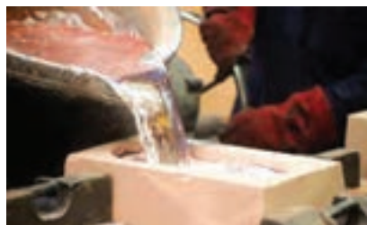
شکل ۳- ریخته‌گری فلز آلومینیوم
