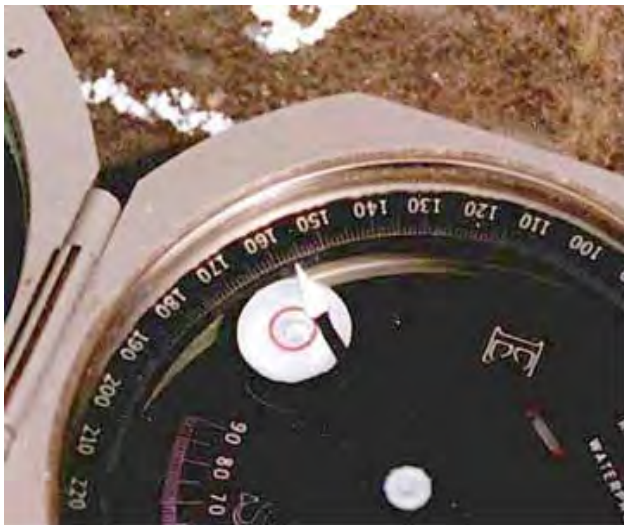
تراز کروی (چشم گاو) باید تنظیم شود
