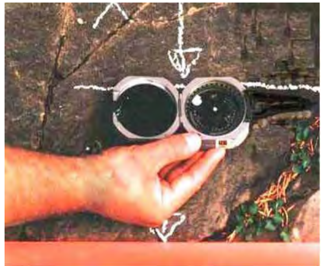
طریقه قرار دادن لبه کمپاس بر روی لایه برای به دست آوردن امتداد لایه
