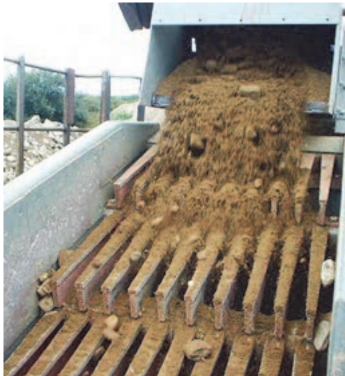
فیدر (تغذیه‌کننده) و سرند گریزلی سنگ‌شکن فکی
