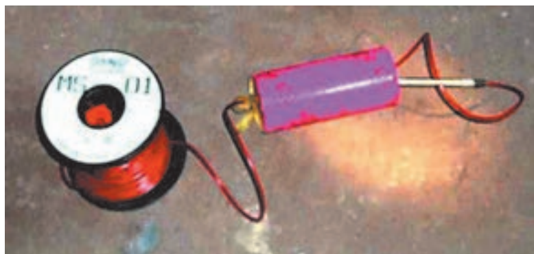
طریقه قرار دادن چاشنی درون دینامیت
