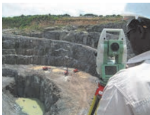
قراول روی از روی نقطه بنچ مارک در بالای پله‌های معدن به نقطه ای با دید کافی در داخل محدوده
