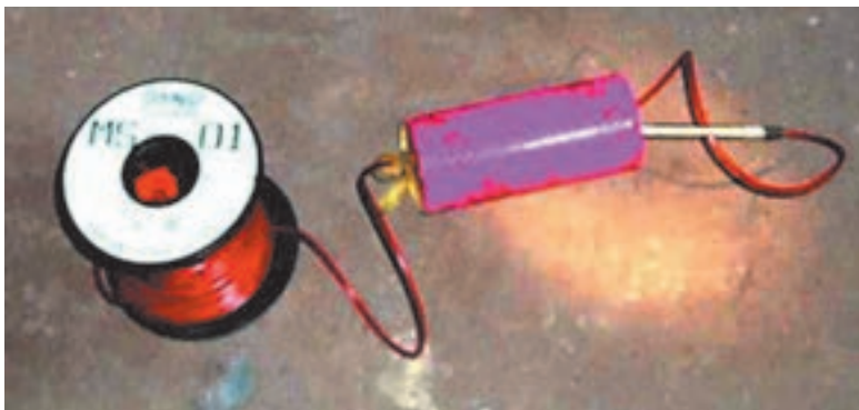
طریقه قرار دادن چاشنی درون دینامیت
