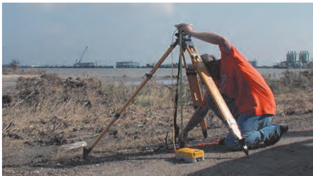
اندازه گیری ارتفاع دوربین تا سطح زمین
