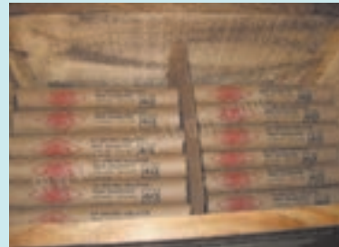
دینامیت های چیده شده درون جعبه چوبی
