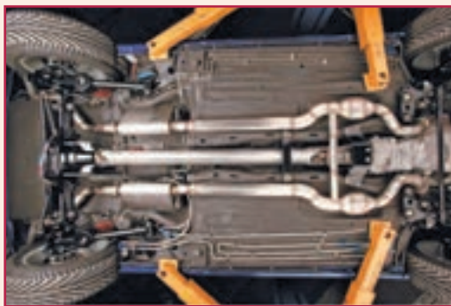
شکل ۳۱-۵ میل گاردان بارگذاری پیچشی را برای انتقال گشتاور تحمل می نماید.
