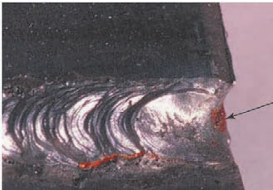
شکل ۵-۳۲- به ریشه جوش نگاه کنید تا مطمئن شوید که ذوب کامل اتفاق افتاده است
