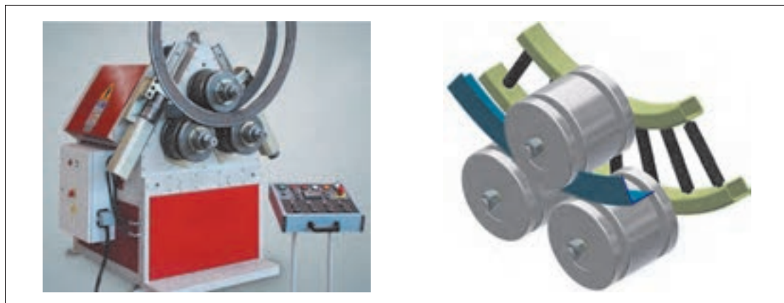
شکل ۳-۱۷- دستگاه خم کن سه غلتکی افقی
