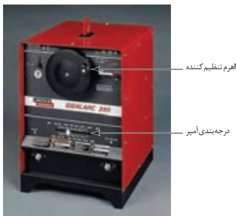
شکل ۴-۱۶: دستگاه جوشکاری با سیم پیچ متحرک
