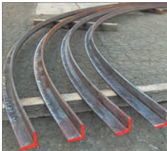
شکل ۳-۲۱- پروفیل با شعاع خم متفاوت
