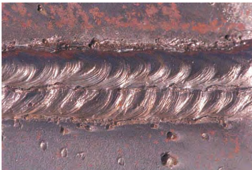
شکل ۴۰-۱: اندازه گرده جوش در پاس پوششی
