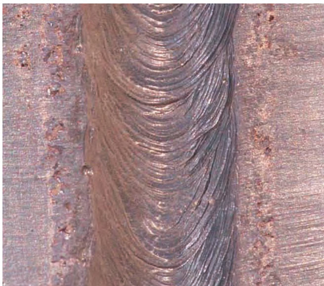
شکل ۲۷-۱: ساق جوش یکنواخت (toe)
