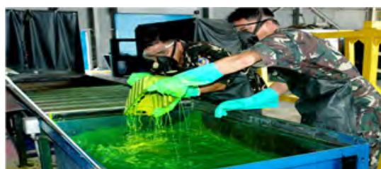
روش غوطه‌وری در مخزن مایع نافذ
