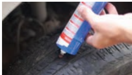
شکل ۲۷- مراحل پنچرگیری تایر بدون تیوب
