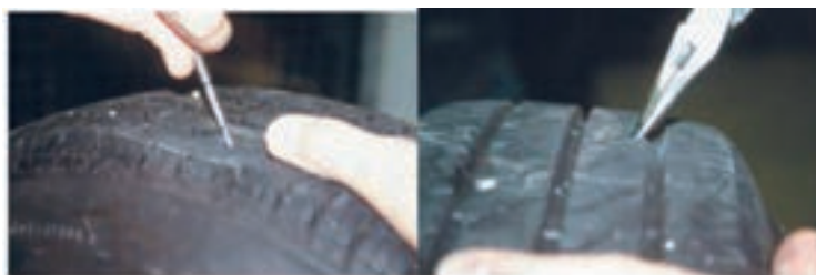
شکل ۲۲- روش بررسی و خارج کردن جسم خارجی از تایر
