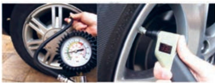
شکل ۲۱- شیوه بررسی و تنظیم فشار باد تایر
