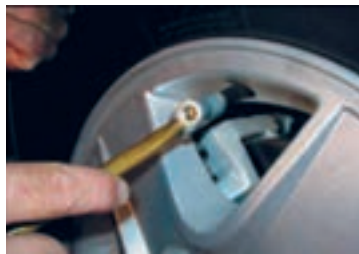
استفاده از ابزار گیج فشار مناسب
