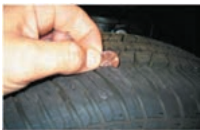
شکل ۱۷- نحوه اندازه‌گیری تقریبی شیار تایر
