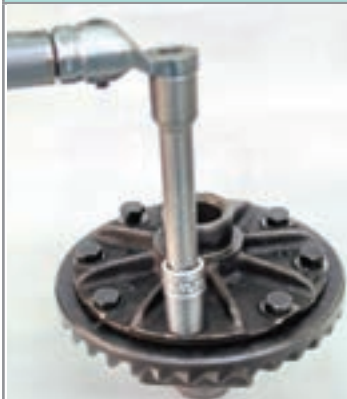
شکل ۵۰-۴- بستن پیچ‌های کرانویل
