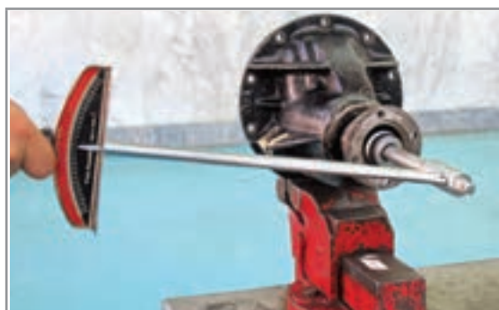
شکل ۴۸-۴-ب تعیین گشتاور پیش بار با گشتاورسنج
