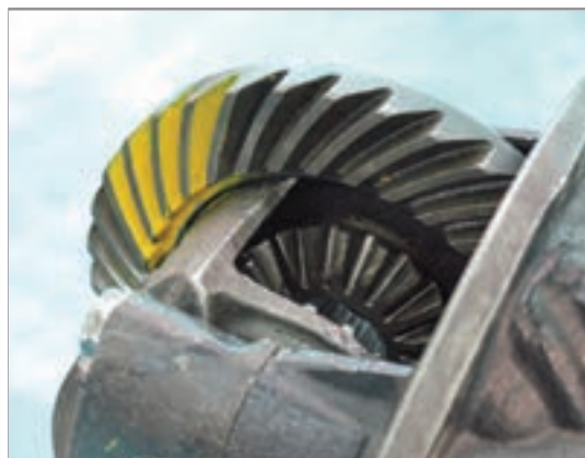
شکل ۴-۲۸- استفاده از رنگ برای کنترل
