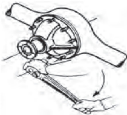
شکل ۵۶-۴- اعمال گشتاور مناسب هنگام بستن
