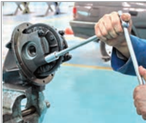
شکل ۵۳-۴- بستن کپه یاتاقان‌ها
