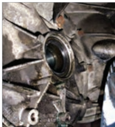
شکل ۲۶-۵- بررسی محل نصب پلوس
