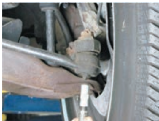
شکل ۳۳ - روش گریس کاری سیبک
