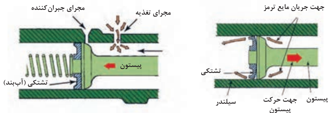
شکل ۱۲- عملکرد تشکی پیستون
