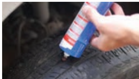
شکل ۲۷- مراحل پنچرگیری تایر بدون تیوب
