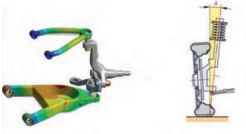
شکل ۱۵- سگدست و محور آن
