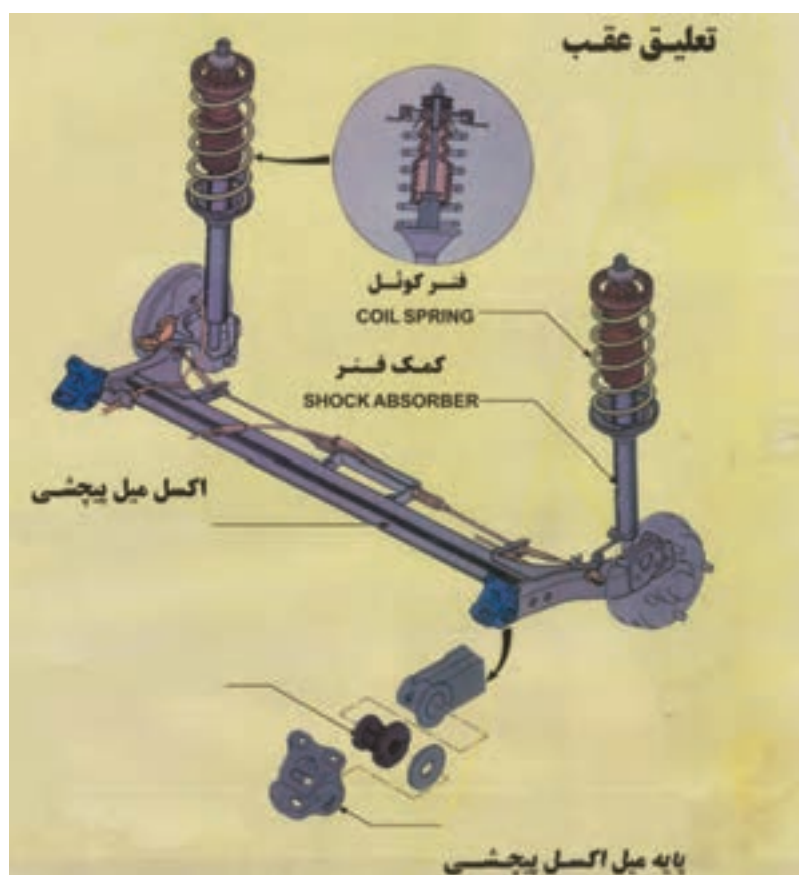
شکل ۴۸- تعلیق با اکسل میل پیچشی
