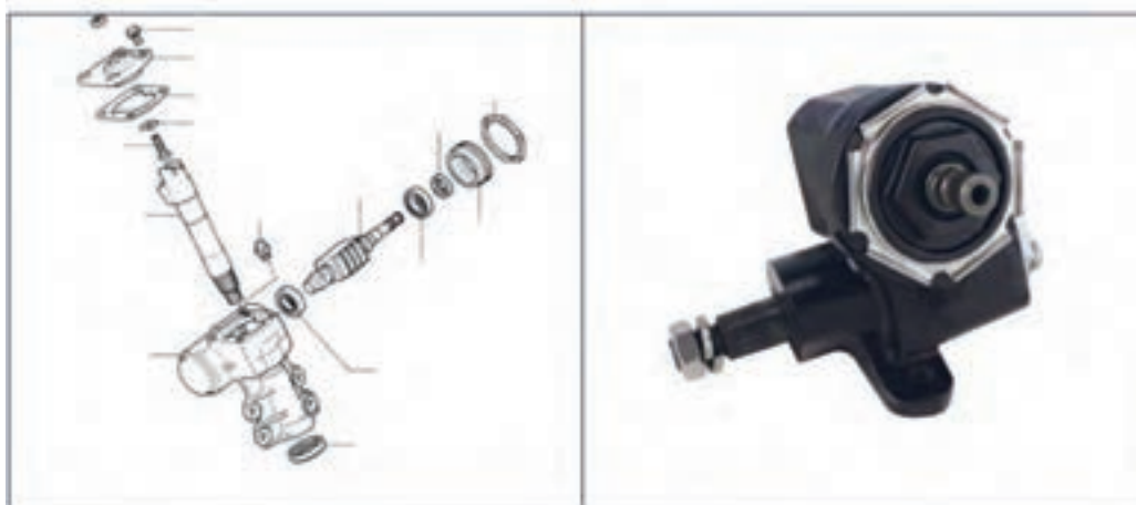
شکل ۲۹ - نوعی مکانیزم تنظیم لقی طولی مارپیچ فرمان
