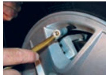
استفاده از ابزار گیج فشار مناسب
