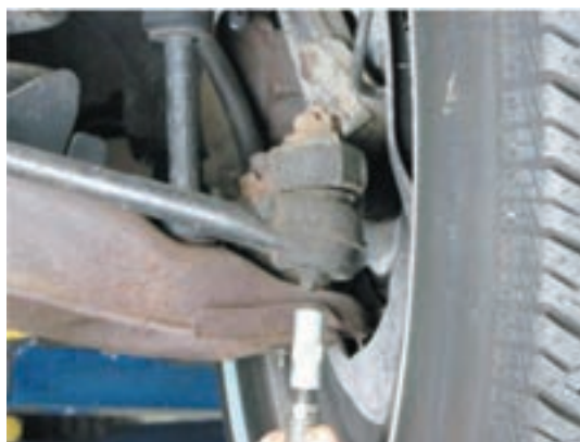
شکل ۳۳ - روش گریس کاری سیبک
