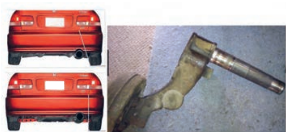
شکل ۴۵- خرابی بوش‌ها و تأثیر آن روی چرخ
