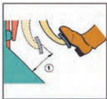
شکل ۱۶- بازدید فاصله پدال ترمز تا کف
