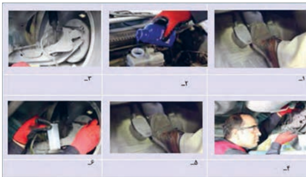
شکل ۱۹- مراحل هواگیری دستی مدار هیدرولیک ترمز
