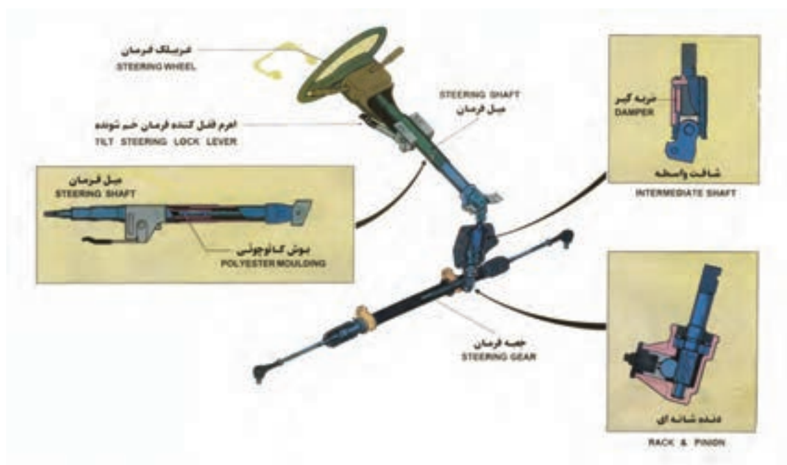
شکل ۲ - مجموعه فرمان و اجزای آن
