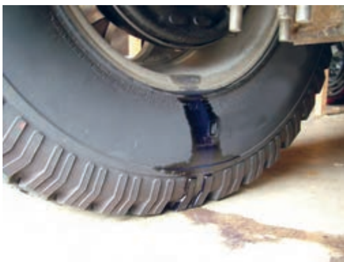
شکل ۴۱- وجود مایع اطراف چرخ عقب
