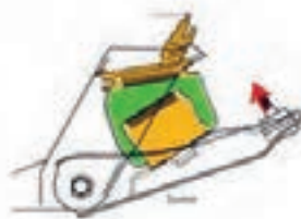
شکل ۲۴- فنر بادی و نحوه‌ی عملکرد آن
