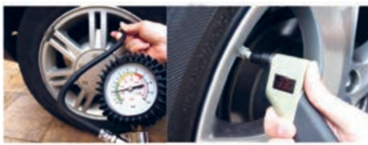
شکل ۲۱- شیوه بررسی و تنظیم فشار باد تایر
