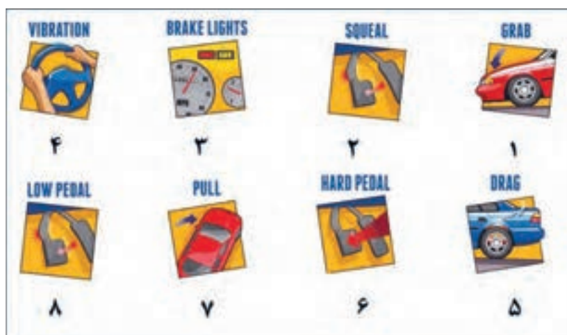
شکل ۲۱- آثار مهم خرابی سیستم ترمز
