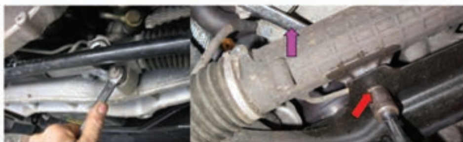
شکل ۲۰ - سفت کردن اتصالات جعبه فرمان
