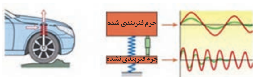
شکل ۲۶- عملکرد سیستم فنربندی تعلیق
