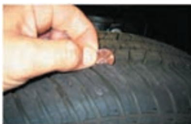
شکل ۱۷- نحوه اندازه‌گیری تقریبی شیار تایر
