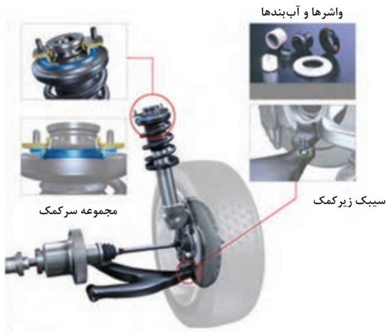
شکل ۳۴- برخی نقاط قابل تعمیر تعلیق مک فرسون
