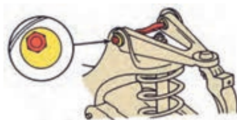
شکل ۳۹- مجموعه تعلیق طبق دار دویل و روش تنظیم زوایا
