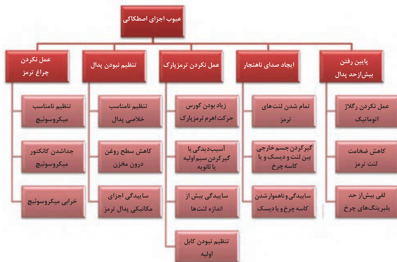
شکل ۲۳- عیوب اجزای اصطکاک‌ی
