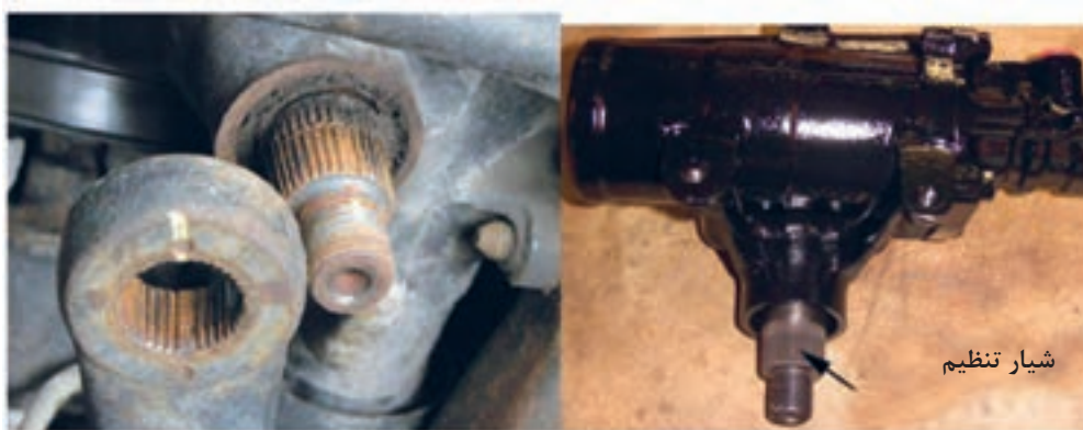
شکل ۳۲ - هزار خار محور خروجی جعبه فرمان
