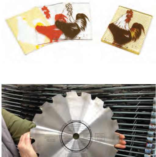
شکل ۱۲-۲ مقایسه تصویر چاپ شده بر روی سطوح نرم و صاف با سطوح زبر و ناصاف
