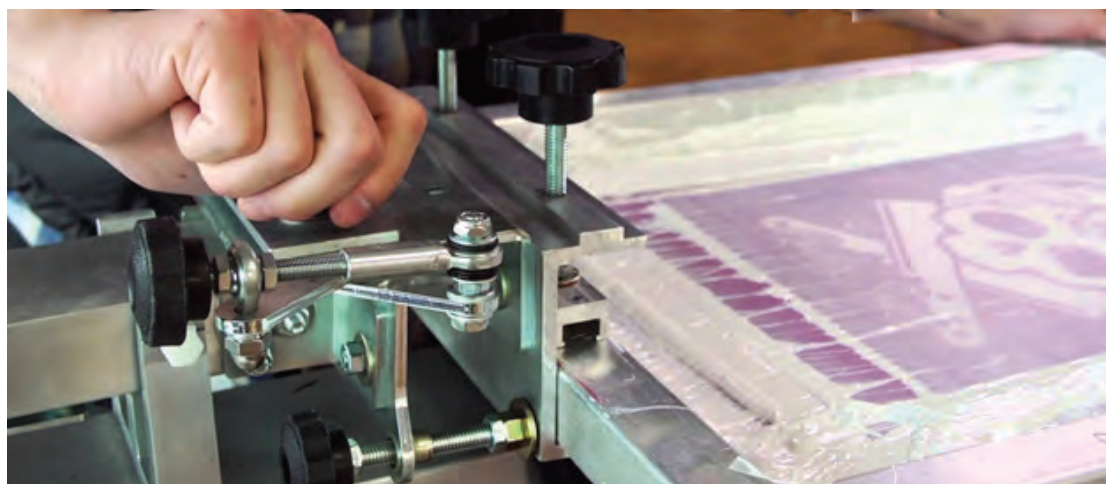
(شکل ۴-۴) گونیا کردن طولی و عرضی شابلون
