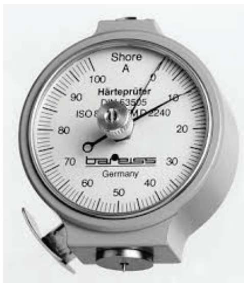
شکل ۴-۸۸ سختی سنج عقربه ای و دیجیتالی
