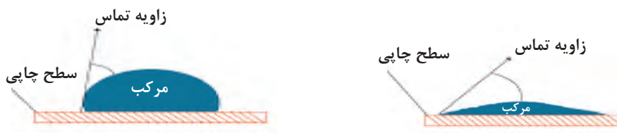
شکل ۳-۴۰ رابطه انرژی سطحی و زاویه تماس
