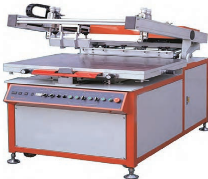
شکل ( ۴- ۲۹ ) گیره شابلون در ماشین چاپ مجهز به وکیوم
