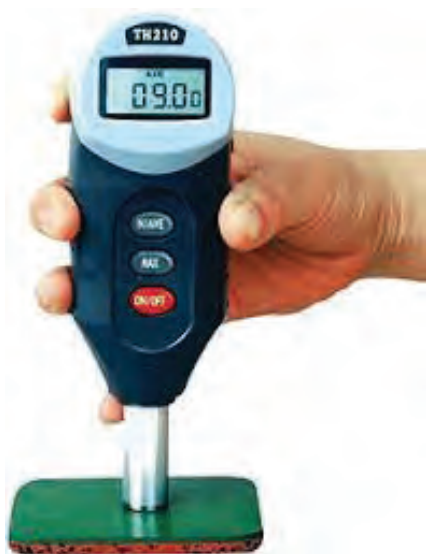
شکل ۴-۸۸ سختی سنج عقربه ای و دیجیتالی
