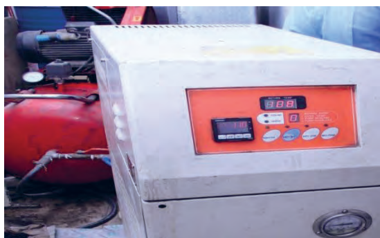
شکل ۲۷- سیستم گرمایشی سیلندر فشار
