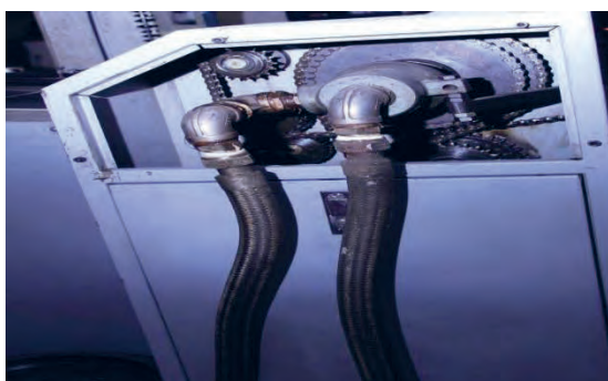
شکل ۲۷- سیستم گرمایشی سیلندر فشار
