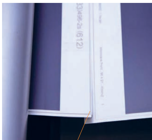
شکل ۳۵ - اورلب کار چاپی و درجه تنظیم آن
