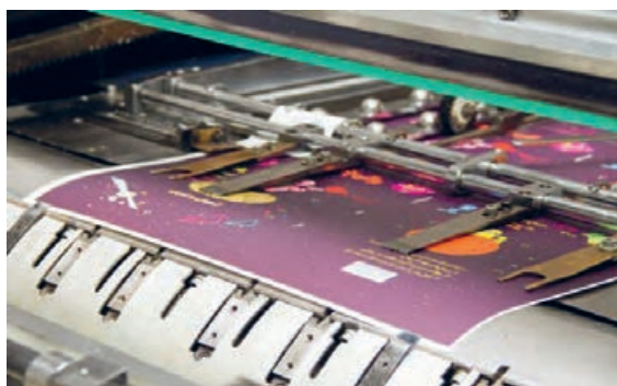
شکل ۱۷- سیستم شابلونی ورنی زنی رابه همراه پنجه‌ها و روزنه‌های سیلندر
