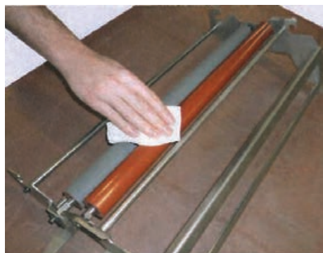
شکل ۳۰ - تمیز کردن نوردهای فیوزر
