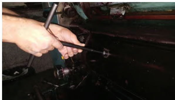
شکل ۶۵- باز کردن قاب لاستیک
