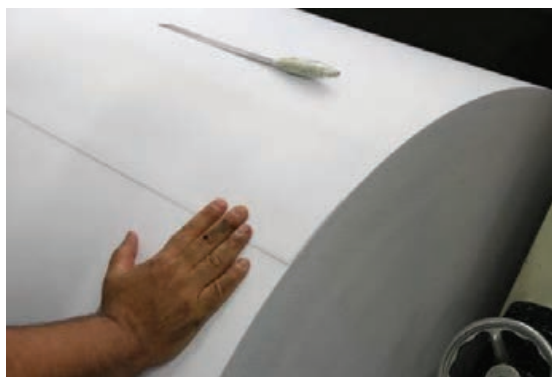
شکل ۱۶- تا کردن لبه رول
