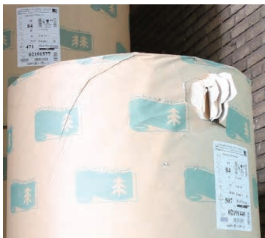
شکل ۶- خراش و پارگی روی بدنه رول
