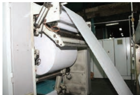
شکل ۹- سیستم عملکرد تغذیه بدون توقف (Splicer)
