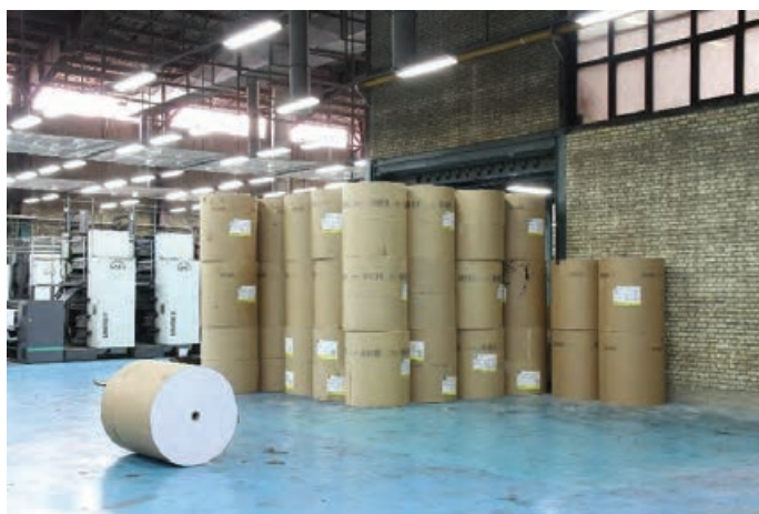
شکل ۱- حالت درست قرار گرفتن رول‌های کاغذ
