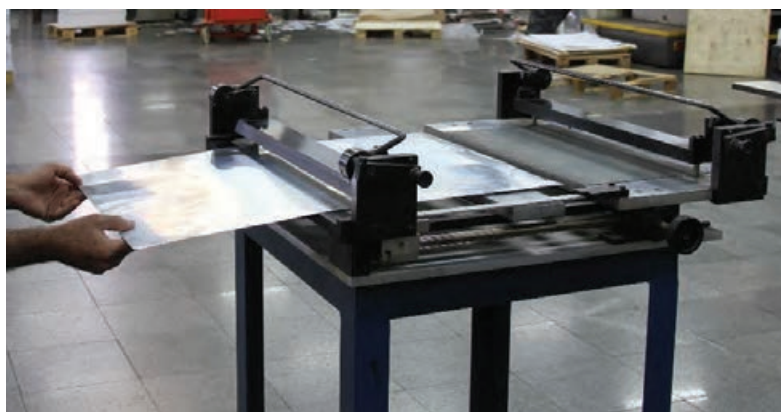
شکل ۶۲- قرار دادن پلیت در دستگاه خم‌کن
