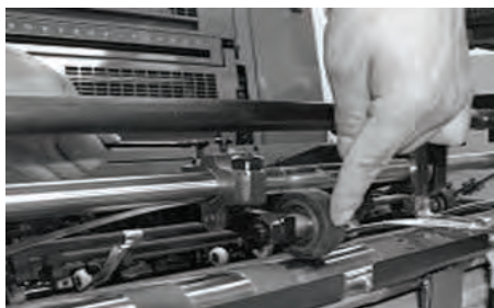
شکل ۳۲- تنظیم فشار قرقره
