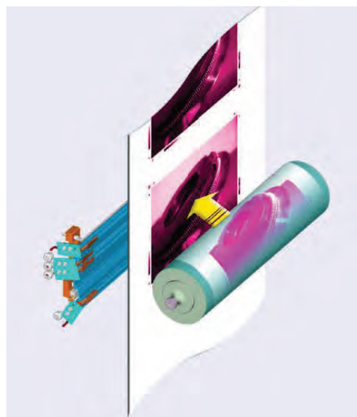
شکل ۳۵- انتقال تصویر روی سطح چاپ شونده
