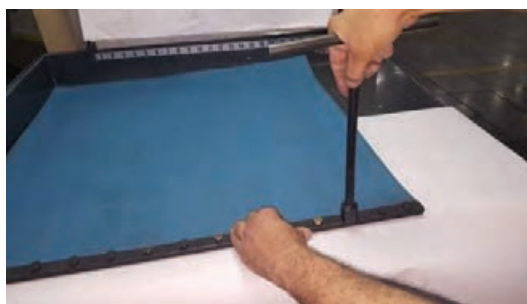
شکل ۶۰- نصب گیره لاستیک
