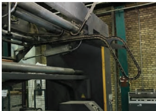
شکل ۲۶- سیستم کاغذ کشی زنجیری
