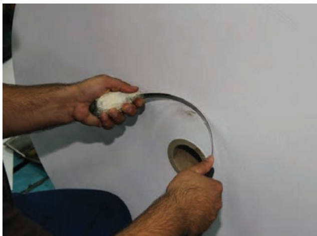
شکل ۵- برطرف کردن آسیب روی بدنه رول
