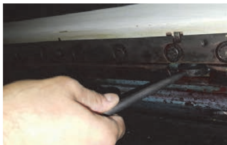
شکل ۸۱ - پیچ تنظیم لبه کار
