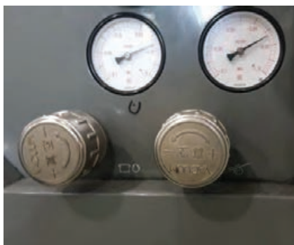
شکل ۴۲- شیر تنظیم مکش (شیر سمت چپ)
