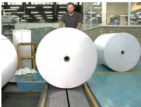
شکل ۱۵- انتقال رول از ریل به روی واگن
