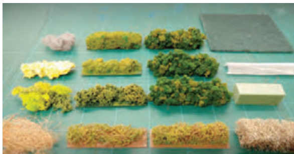
بوته‌های ساخته شده از جنس‌های مختلف مانند اسکاچ، الیاف مصنوعی، اسپری فوم، الیاف نارگیل، فوم فشرده و...
