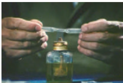
ساخت بطری‌های شیشه‌ای از لوله خودکار
