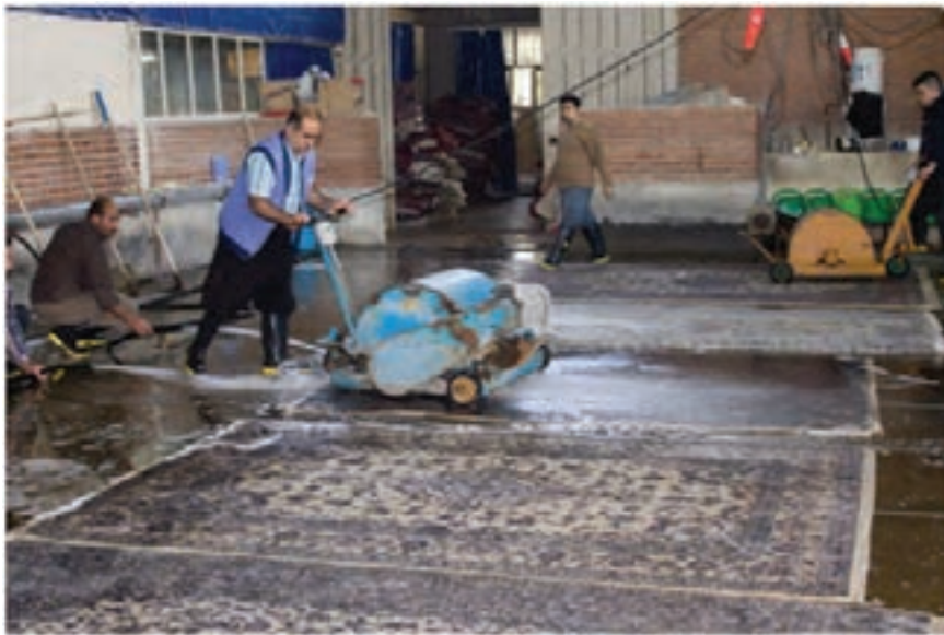
شکل ۱۰۸- شست‌وشوی فرش با ماشین در کارگاه‌های تخصصی
