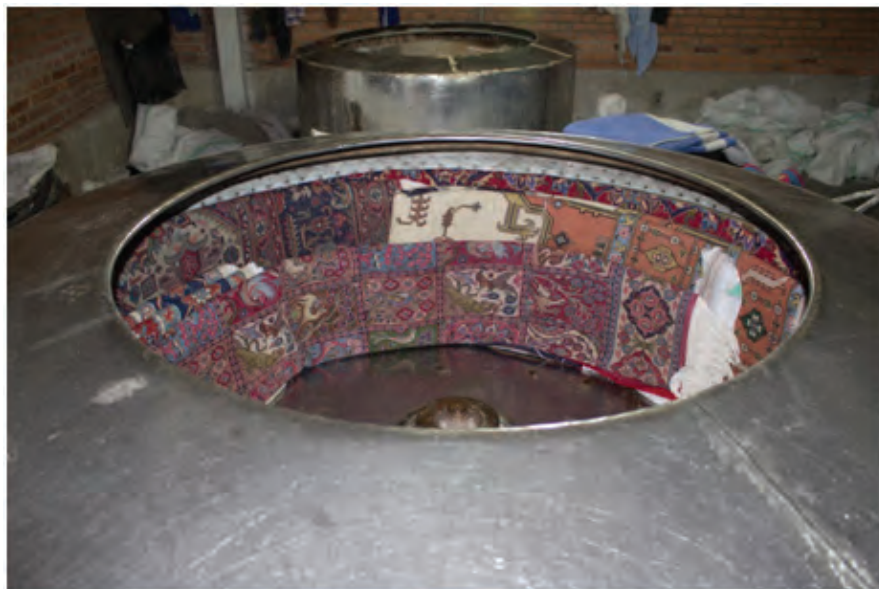
شکل ۱۱۱ - دستگاه آبگیری فرش
