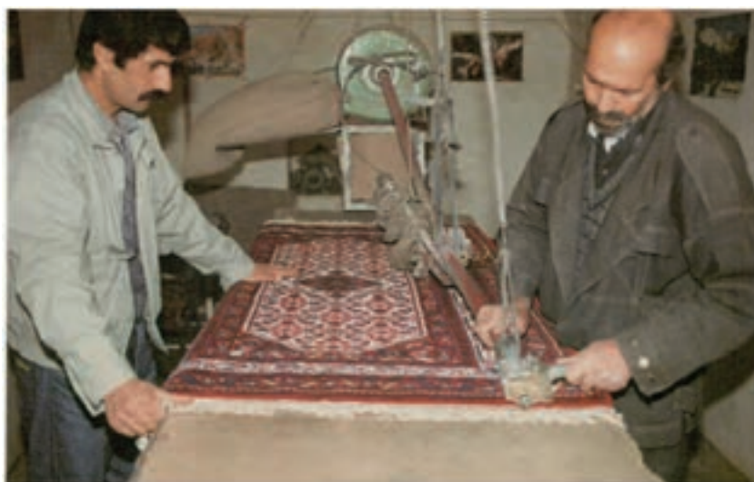
شکل ۹۴- قیچی برقی یا دستگاه پرداخت
