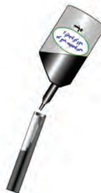
۲- ریختن مرکب مخصوص درون مخزن قلم
