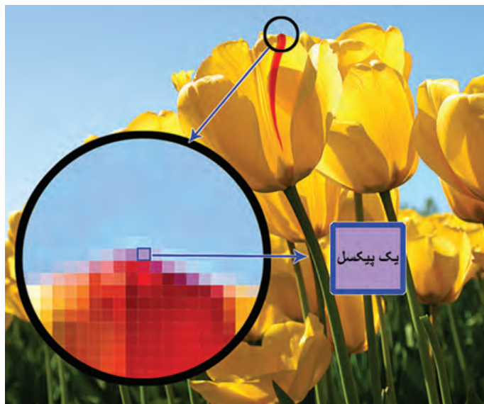
شکل ۴-۴ - پیکسل کوچک‌ترین جزء یک تصویر دیجیتالی است.
