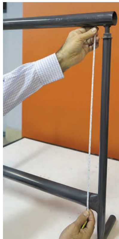
تصویر ۱-۶ ▲ اندازه گیری فاصله داخلی سمت راست دار
