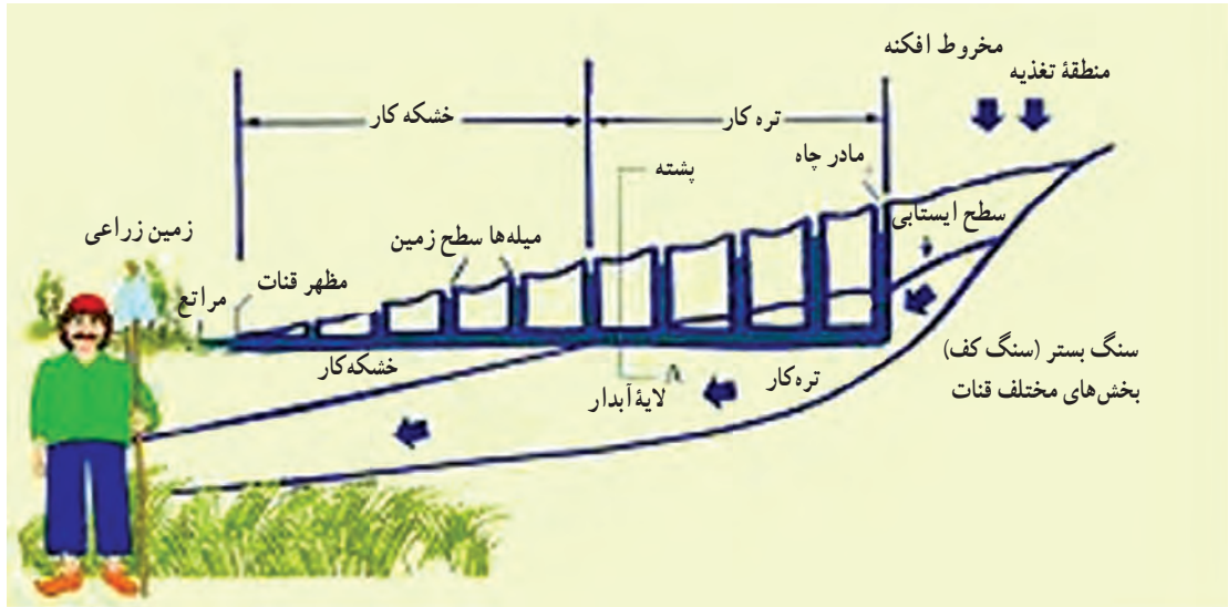
شکل ۳۱-۳- شمای یک قنات
