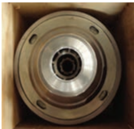
شکل ۵-۶- سپراتور و صفحات داخلی آن
