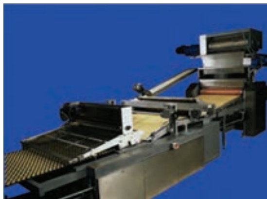
شکل ۱۳- فر تونلی پخت بیسکویت
