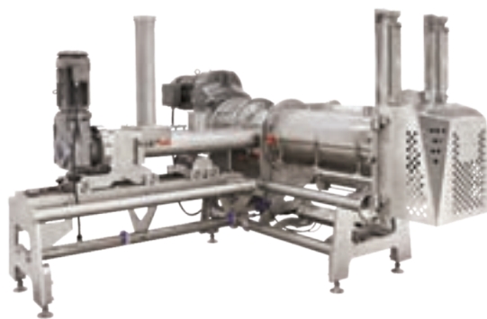
شکل ۳- مخلوط‌کردن بیسکویت به روش مداوم
