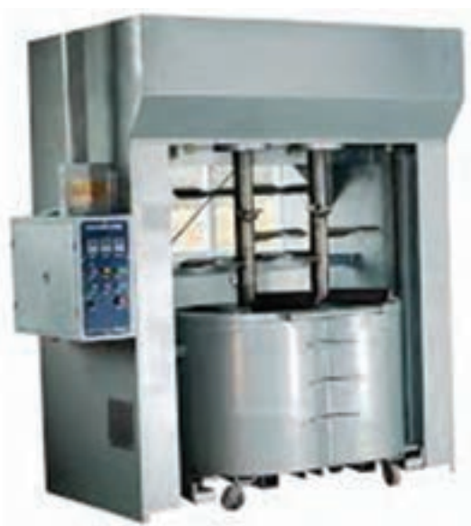
شکل ۱- مخلوط‌کن عمودی با مخزن قابل جدا شدن
