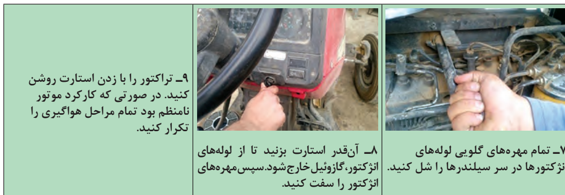
شکل ۴۰-۱- مراحل هواگیری سیستم سوخت رسانی
