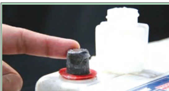
شکل ۲۰-۱- مالیدن گریس به قطب‌ها
