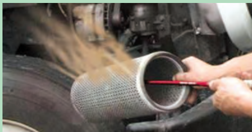
شکل ۳۵-۱- تمیز کردن صافی خشک با فشار هوا
