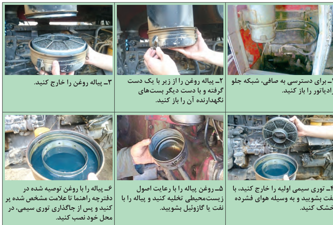
شکل ۱-۳۲- مراحل سرویس صافی روغنی
