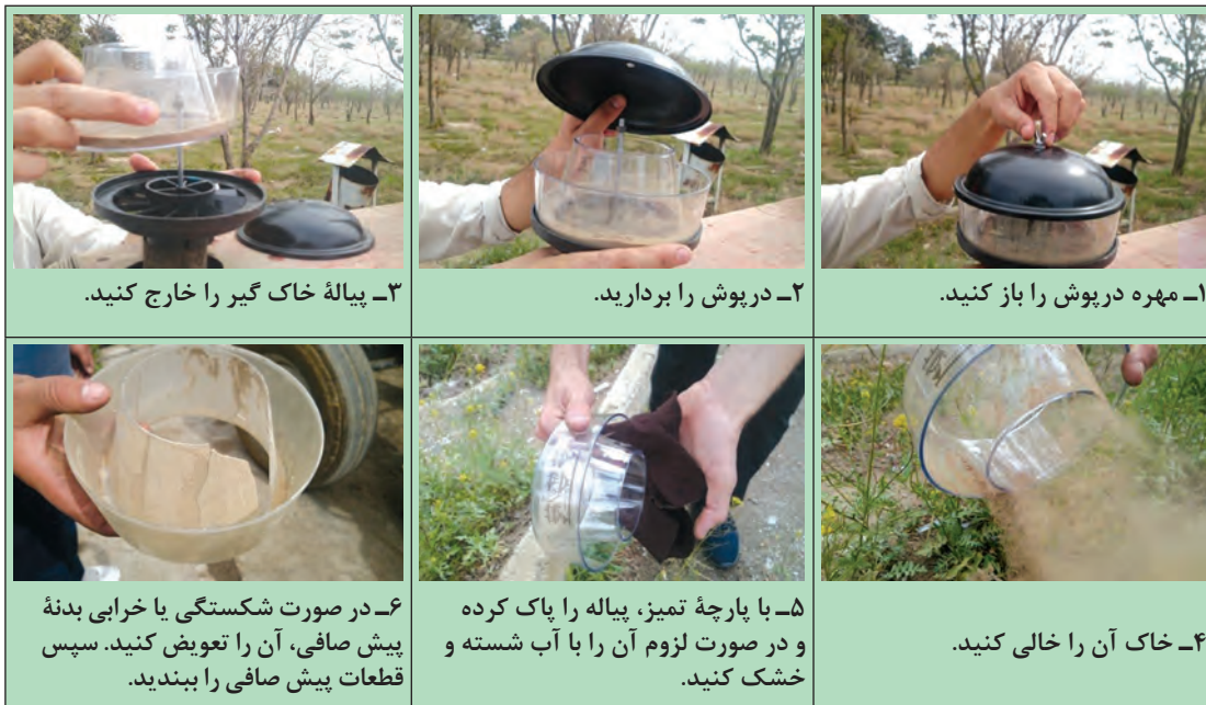
شکل ۳۱-۱- مراحل تمیز کردن پیش صافی
