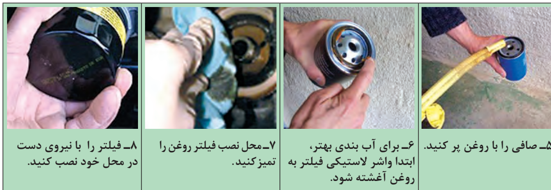
شکل ۵۰-۱- مراحل تعویض صافی روغن
