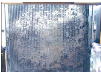
شکل ۱-۴۴- رادیاتور با شبکه کثیف
