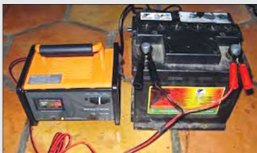
شکل ۵۲-۱- روش شارژ باطری با شارژر
