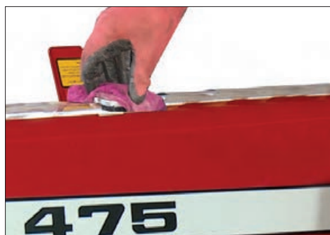
شکل ۴۵-۱ نحوه باز کردن درب رادیاتور
