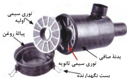
شکل ۲۶-۱- اجزای تشکیل دهنده صافی روغنی
