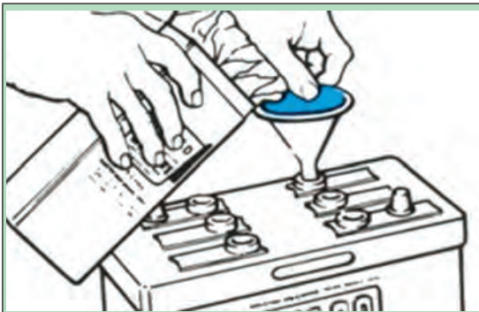
شکل ۲۲-۱- اضافه کردن آب مقطر به سلول‌ها در صورت نیاز
