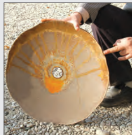
شکل ۱۸-۴- شکستگی نقطه اتصال و بشقاب
