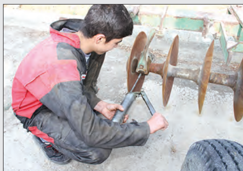
شکل ۲۱-۴- گریس کاری دیسک
