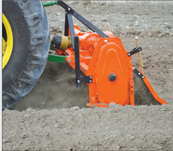
شکل ۳۴-۴- تنظیم درپوش و عمق کار
