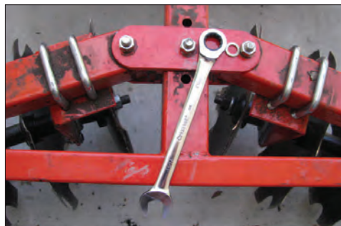
شکل ۲۸-۴ تغییر زاویه استقرار ردیف بشقاب‌ها روی شاسی
