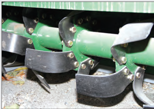
شکل ۲۲-۴- وضعیت درپوش و تیغه‌ها در گاوآهن دوار
