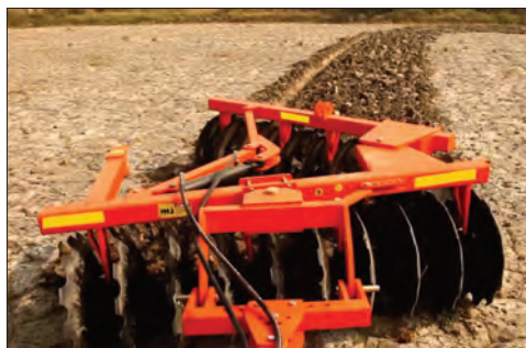
شکل ۲۸-۴ تغییر زاویه استقرار ردیف بشقاب‌ها روی شاسی
