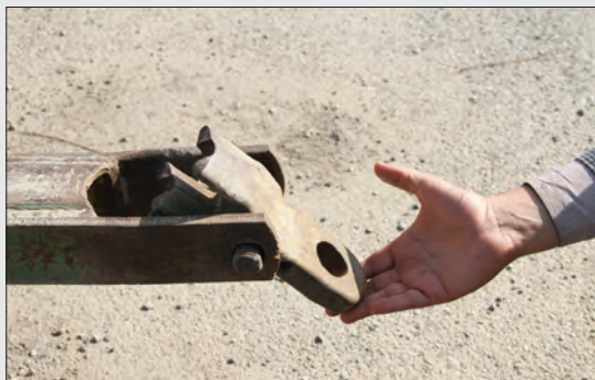
شکل ۱۲-۵- شکستگی نقطه اتصال صاف کننده
