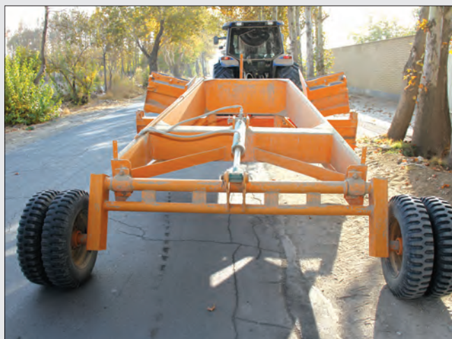
شکل ۱۸-۵- تنظیم وضعیت چرخ ها به روش مکانیکی
