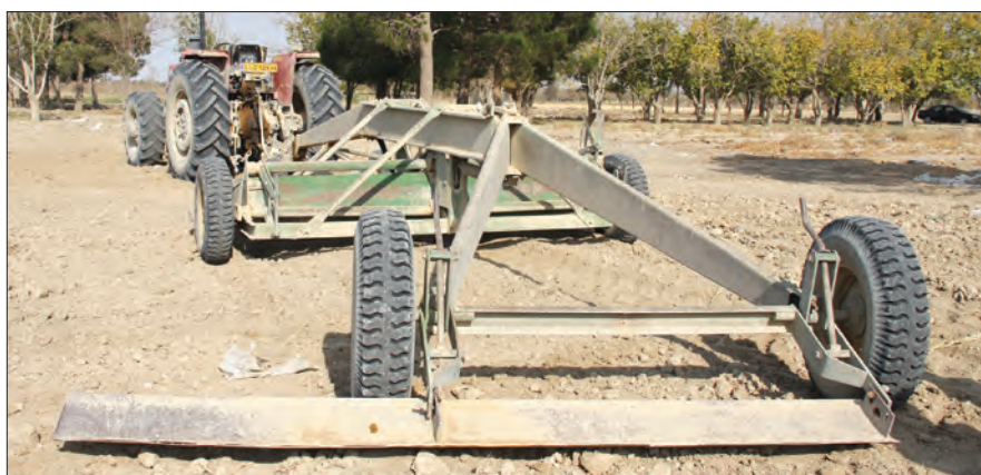
شکل ۸-۵- صفحه متحرک در انتهای لولر برای تکمیل تسطیح
