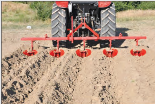
شکل ۳۲-۵- شیارکش در حال ایجاد شیار
