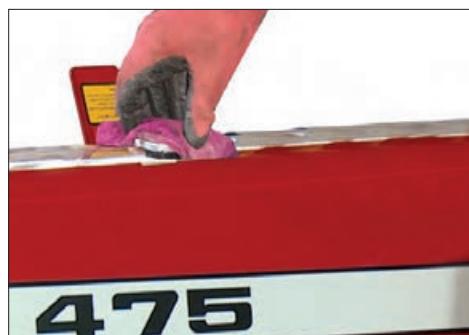
شکل ۴۵-۱ نحوه باز کردن درب رادیاتور
