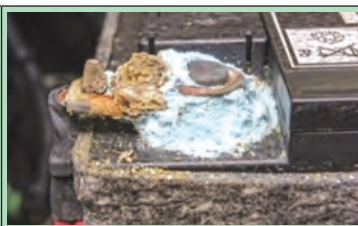
شکل ۱۶- سولفاته شدن قطب‌های باتری
