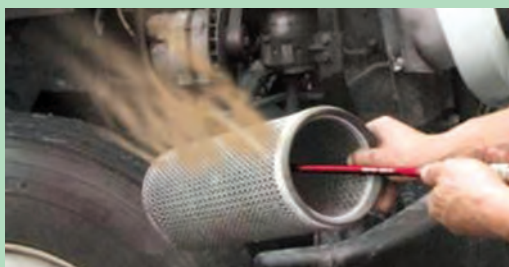
شکل ۳۵-۱- تمیز کردن صافی خشک با فشار هوا
