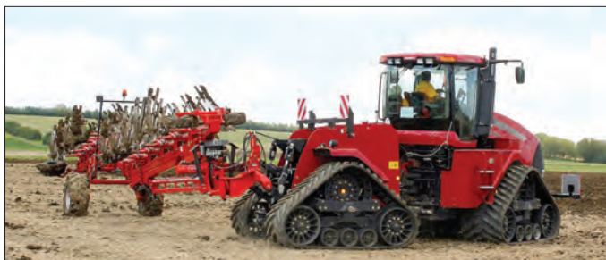
شکل ۵-۱- تراکتور چرخ زنجیری
