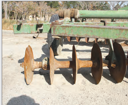
شکل ۱۹-۴ یاتاقان خراب بشقاب
