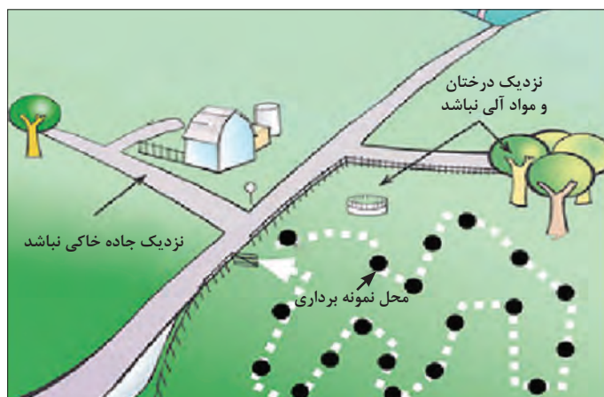
شکل ۱۱-۲ تعیین محل نمونه برداری
