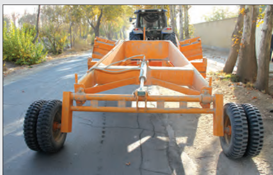
شکل ۱۴-۵- صاف کننده نیمه سوار
