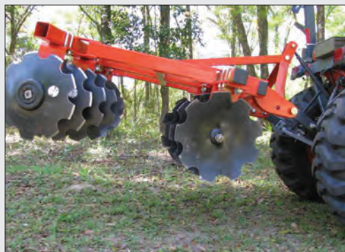
شکل ۲۹-۴- مالبند بلند و اتصال سه نقطه
