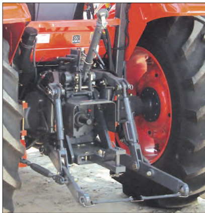
شکل ۳۲-۳- زنجیر تنظیم تعادل یا نوسان گیر
