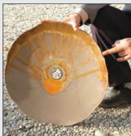
شکل ۱۸-۴- شکستگی نقطه اتصال و بشقاب
