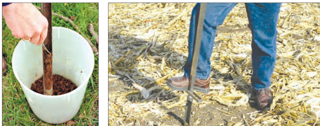
شکل ۹-۲- برداشت نمونه خاک با اگر
