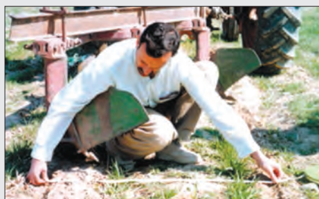
شکل ۳۷-۳- اندازه‌گیری عرض کار گاواهن برگردان دار
