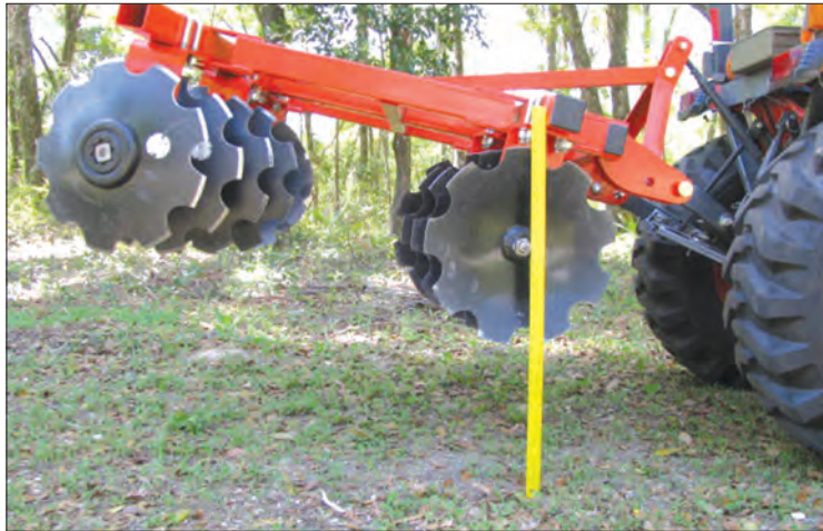
شکل ۴-۶- دیسک سوار
