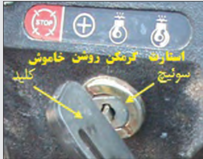
شکل ۱۴-۱ سوئیچ و وضعیت‌های آن
