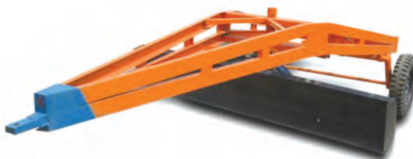
شکل ۷-۵- انواع نیمه سوار و کششی
