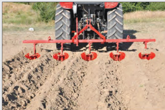
شکل ۳۲-۵- شیارکش در حال ایجاد شیار
