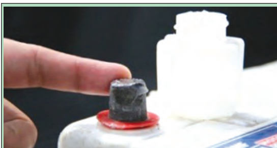
شکل ۲۰- مالیدن گریس به قطب‌ها
