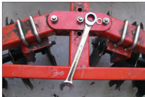
شکل ۲۸-۴ تغییر زاویه استقرار ردیف بشقاب‌ها روی شاسی
