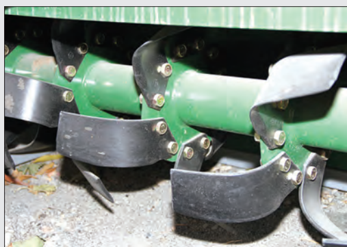
شکل ۲۲-۴ وضعیت درپوش و تیغه‌ها در گاوآهن دوار
