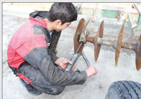
شکل ۲۱-۴- گریس کاری دیسک
