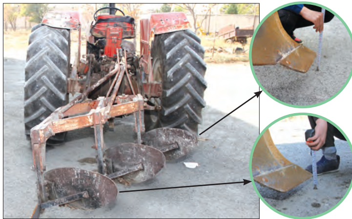
شکل ۳۰-۳- تراز طولی گاوآهن
