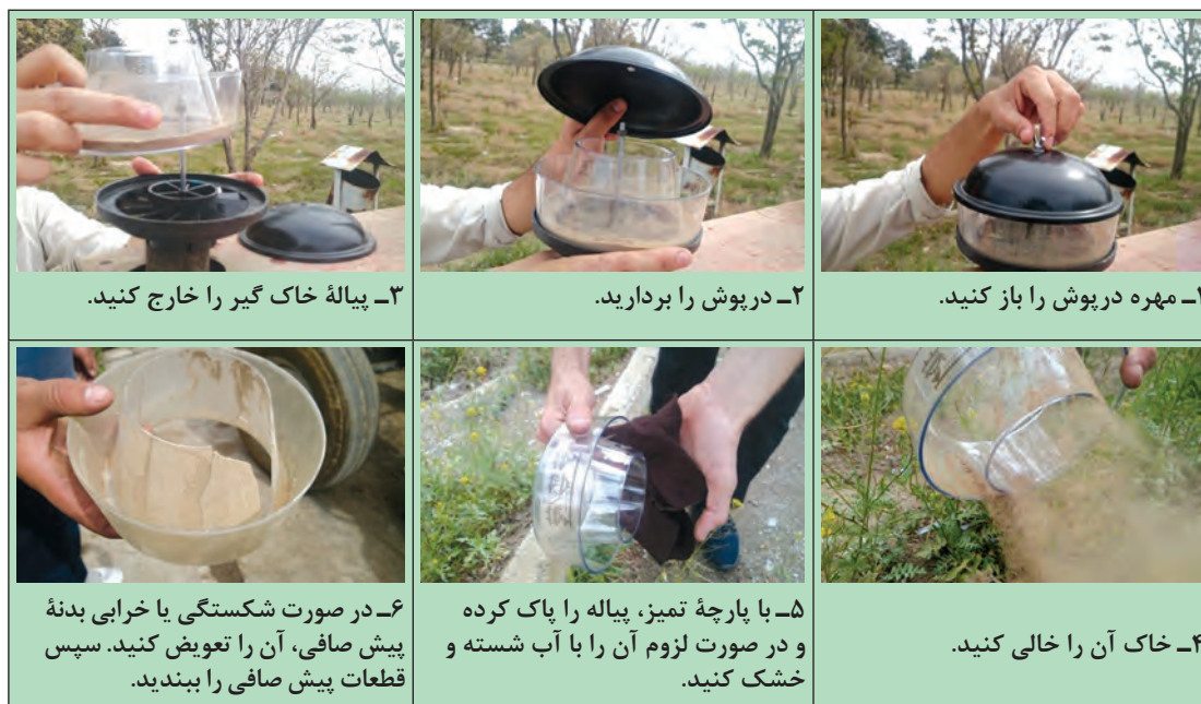
شکل ۳۱-۱- مراحل تمیز کردن پیش صافی
