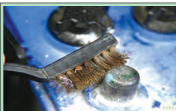
شکل ۱۷- تمیز کردن قطب‌ها با برس سیمی
