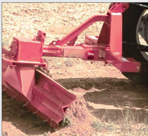
شکل ۲۶-۲ تیغه پشت تراکتوری متصل به تراکتور
