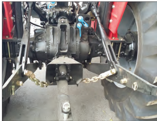
شکل ۳۲-۳- زنجیر تنظیم تعادل یا نوسان گیر
