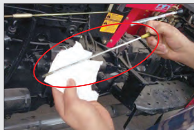
شکل ۹-۱ میله اندازه گیری
