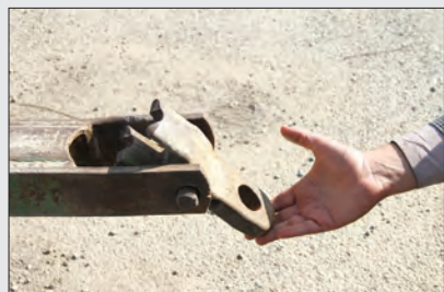
شکل ۱۸-۴- شکستگی نقطه اتصال و بشقاب
