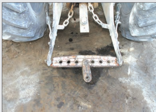
شکل ۲۹-۴- مالبند بلند و اتصال سه نقطه
