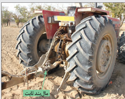
شکل ۱۶-۵- نقطهٔ اتصال در صاف‌کننده کششی
