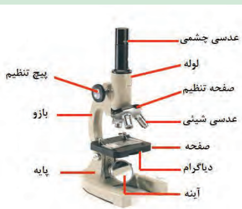
شکل ۲۳- اجزای مختلف نوعی میکروسکوپ
