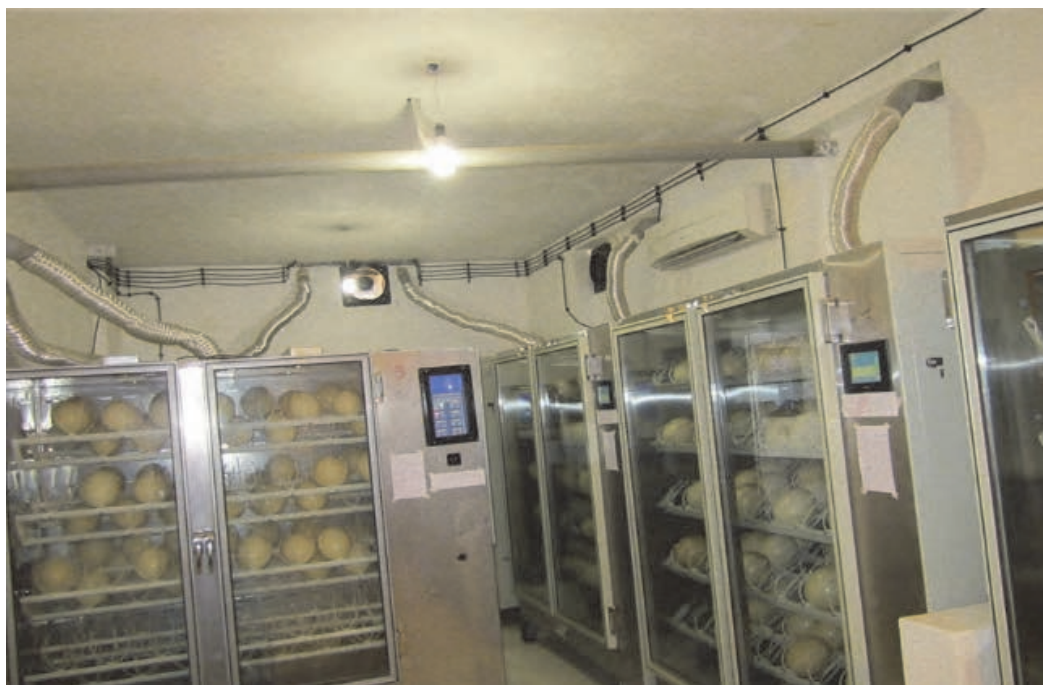
دستگاه ستر مخصوص شترمرغ در سالن جوجه‌کشی
