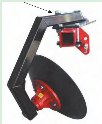
شکل ۴۱-۲. اتصال بشقاب به شاسی
