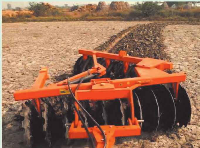
الف. تنظیم زاویه برش به وسیله جک
