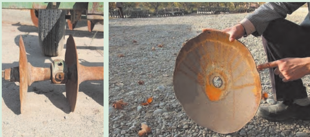
شکل ۱۵-۲. بررسی بشقاب‌ها و یاتاقان‌ها
