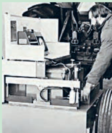
شکل ۳۵- اندازه‌گیری توان یک تراکتور با دینامومتر
