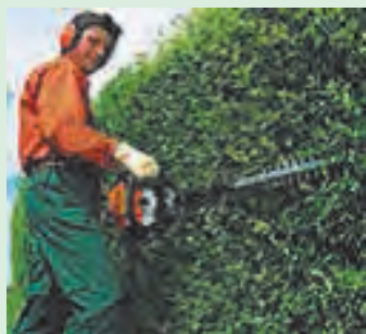
ب- کار در حالت عمودی شکل ۵۹-۴. تنظیم دسته عقب هرس کن
