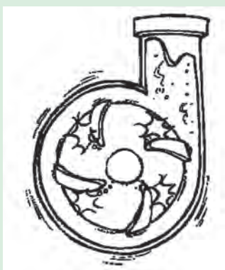
شکل ۲۹-۵. کاویتاسیون در پروانه پمپ
