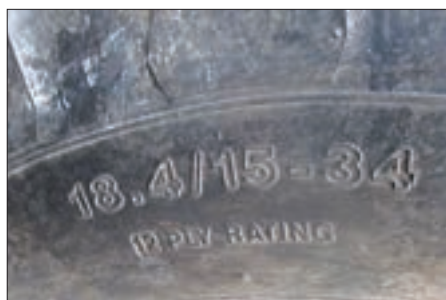
شکل ۱۶-۵ ابعاد تایر تراکتور
