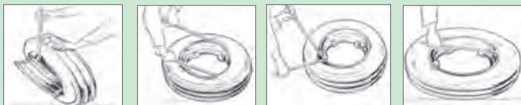
شکل ۵-۲۵ جدا کردن تایر از رینگ یک تکه
