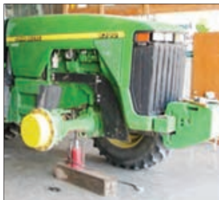
شکل ۲۲-۵ جک زدن زیر تراکتور
