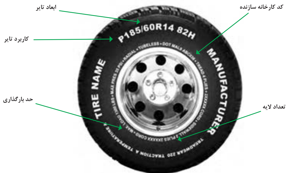
شکل ۱۳-۵- مشخصات فنی و ظاهری تایر
