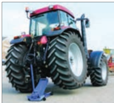
شکل ۲۲-۵ جک زدن زیر تراکتور
