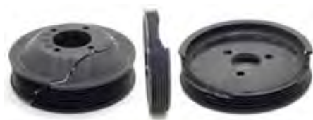
شکل ۶۷-۵- عیوب پولی
