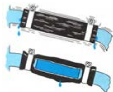
شکل ۵-۵۶- نشتی از شیلنگ ها
